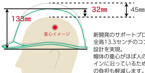
新開発のサポートブロックが全高13.3センチのコンパクト設計を実現。帽体の重心がほぼ人の重心ラインに沿っているため、首への負担も軽減します。
