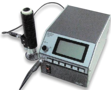
鉄鋼及び各種合金の電気抵抗率を測定し、非破壊で鋼材の種類を判別します。
