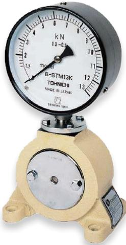
標準ボルトの締め付け特性の簡易測定機です。最適締め付けトルクの調査やねじ締結体の強度試験などに用いられます。
