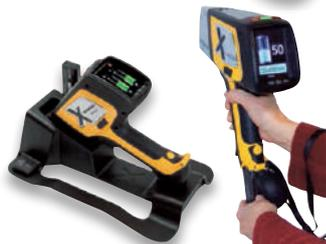
ドッキングステーションは、本体と予備のバッテリーに充電を行い、定期的に装置の状態をチェックします。DELTAは電源を入れたままバッテリー交換ができるホットスワップ機能を搭載しています。
