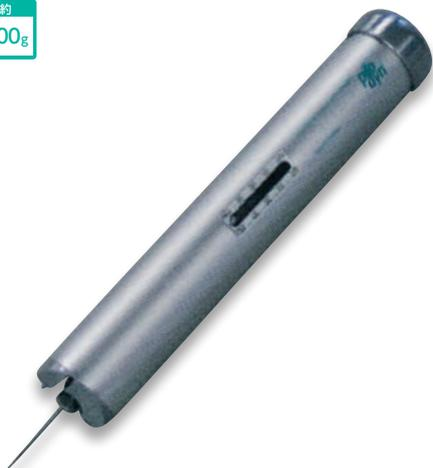
圧縮されたバネの力を用い、一定の力でピンを測定対象に貫入させ、その深さを測定する事により木材、立ち木などの腐食度合いの測定、木材密度の測定ができます。
