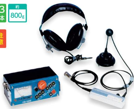
漏水音を音と針の振れで探知できます。出力周波数帯を9種類の中から選定する事によって、管の種類による漏水音の差異や現場で発生している雑音に対して、柔軟に対応できるようになっています。
