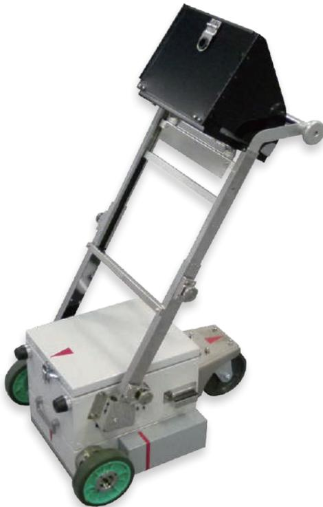
電磁波レーダの原理を用いて、道路下の埋設管（金属管・樹脂管）や空洞を非破壊で探査することができます。
