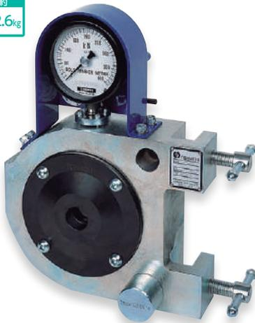
締め付け特性の簡易測定機です。最適締め付けトルクの調査やねじ締結体の強度試験などに用いられます。
