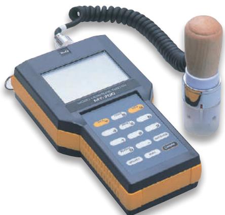
電気抵抗方式による木材水分計です。16種類の樹木データを記憶しており、対象の試料番号を呼び出せば換算することなく、ダイレクトに測定できます。センサの針を木材に刺して測定します。
