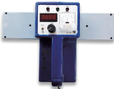
木造建築物の間柱・筋かい検出用の筋かい探知器です。水道の蛇口(金属部分)にケーブルを接続するだけで家屋の間柱・筋交いを探知できます。
