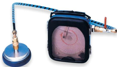
水道管等の水圧変動の記録をとることにより、漏水有無の確認ができます。ご注文の際は、測定圧力と測定時間をご指定ください。
