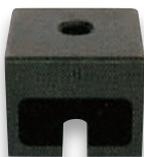
外装タイルなどの付着力を確認できます。また、使用するアタッチメントの面積を入力する事で単位面積あたりの荷重値を表示できます。
